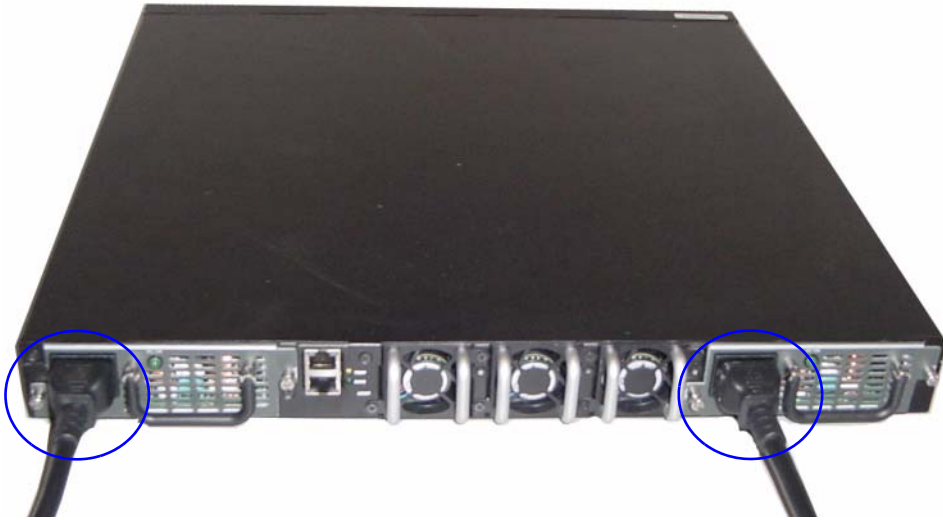
Ilustración 2. Conexión de los cables de alimentación
